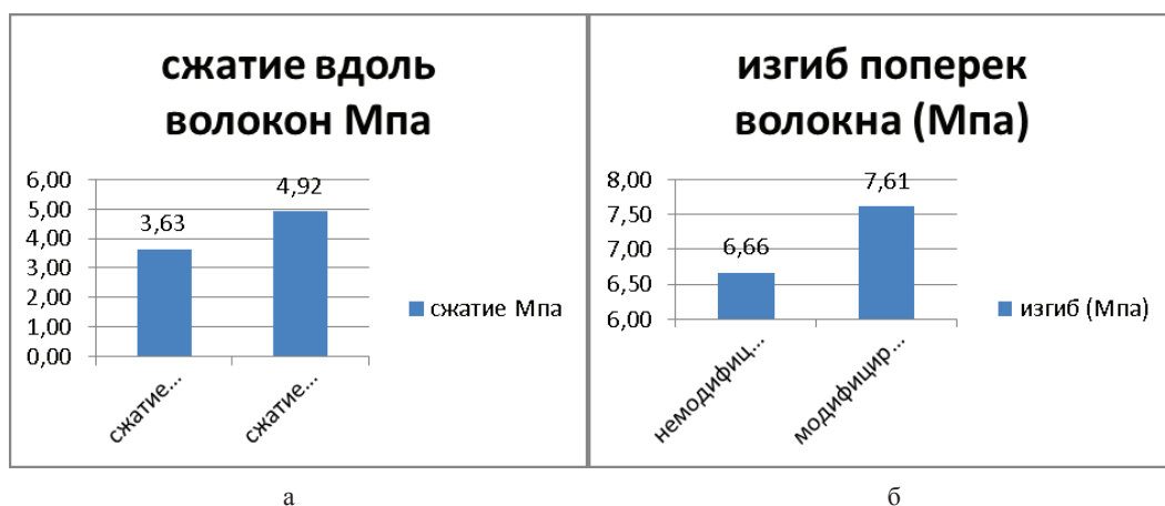
Рис. 9. Результаты испытаний модифицированной и немодифицированной древесины а) на сжатие, б) на статистический изгиб, композицией «Амокор»
